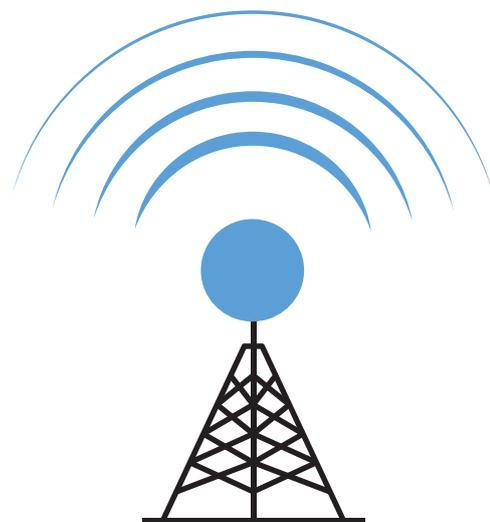
**Runder Signalkegel: Signal strahlt gleichmäßig in alle Richtungen ab – egal ob dort ein Endgerät ist oder nicht.**
